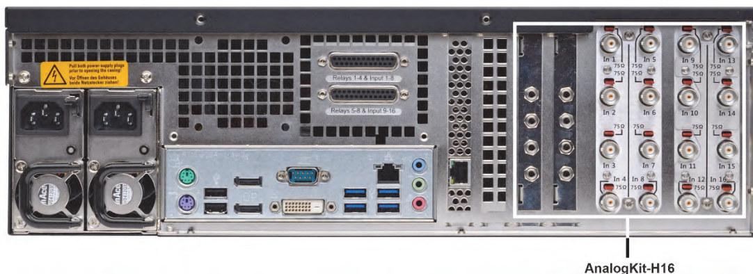
Figure 5 : Entrées FBAS, Entrées audio (3,5mm jack)
