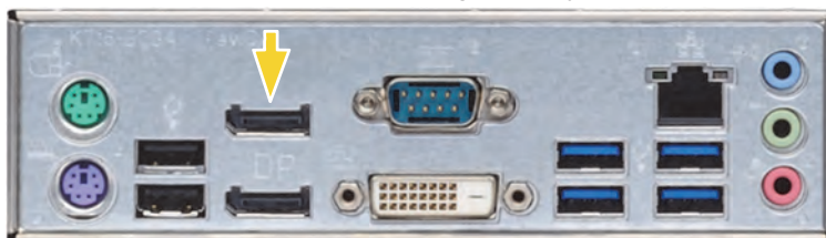
Figure 9 : prise DisplayPort (2x)
