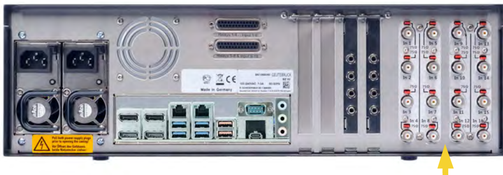
Figure 5 : Entrées FBAS, Entrées audio (3,5mm jack)
