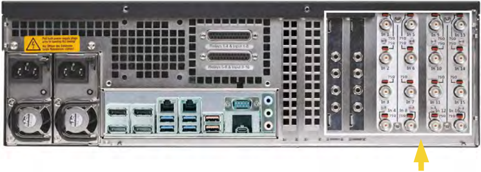
Abbildung 6: AnalogKit-H16 BNC-Eingangsbuchsen und Audio Line In
