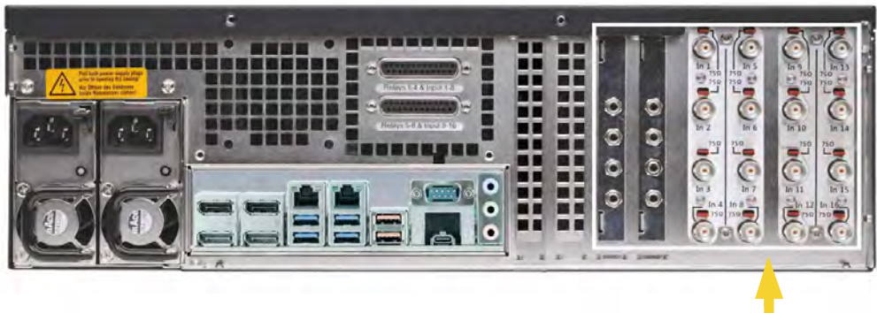
Abbildung 6: AnalogKit-H16 BNC-Eingangsbuchsen und Audio Line In
