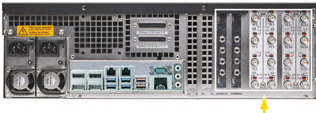
Figura 5: Conexiones de vídeo jacks BNC, Audio Line In
