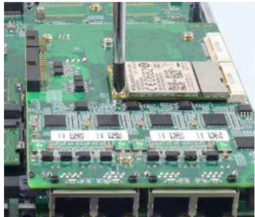
Asegurado con un tornillo de cabeza P M2.5
