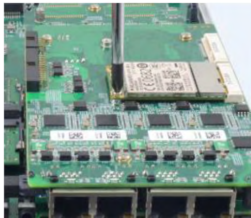
Gesichert mit Rundkopfschraube M2,5
