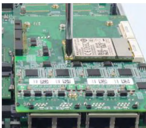
Sécurisé avec la vis à tête P M2.5
