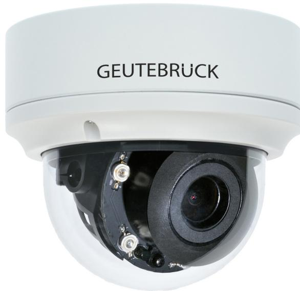
Die Fixdome-Kamera in 4K-Auflösung ist aufgrund der kompakten Bauform ideal vor Sabotage durch z. B. Verdrehen oder Gewalteinwirkungen geschützt. Die Montage ist sowohl an der Wand als auch an der Decke möglich. Das Objektiv inkl. der umgebenen Infrarot-LEDs ist in einer Linie schwenkbar und erlaubt somit einen fest einstellbaren Winkel von 47,5°-115°, passend für die jeweilige Umgebung.
