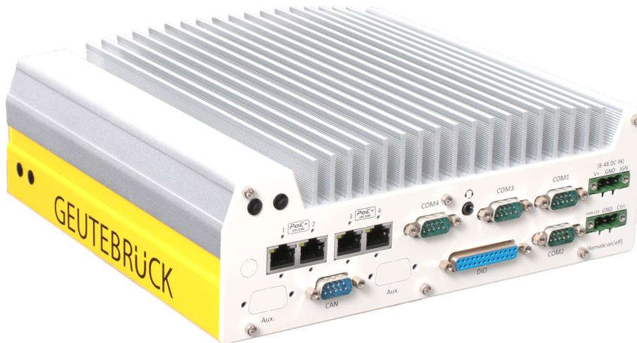
Die Hardware-Plattform ist für den mobilen Einsatz konstruiert und gewährleistet ein optimales Zusammenspiel mit Geutebrück Software. Die zertifizierte Konstruktion kann in Fahrzeugen aller Art eingesetzt und zusätzlich über Funkübertragung (WLAN, Mobilfunk) verbunden werden. Durch die spezielle Bauform wird die Hardware passiv gekühlt. Das Gerät verfügt über vier Netzwerk-Anschlüsse (PoE+).
