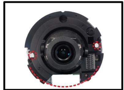
**Schritt 3:** Zeichnen Sie an der Decke/Wand einen Punkt 20 mm über der Mitte der markierten konkaven Kante (wie in der linken Abbildung unten). Legen Sie den markierten Punkt als Mittelpunkt fest, zeichnen Sie ein Kabeleinführungsloch mit 30mm Durchmesser (Radius 15mm) und bohren Sie das Kabeleinführungsloch (wie in der rechten Abbildung unten).
