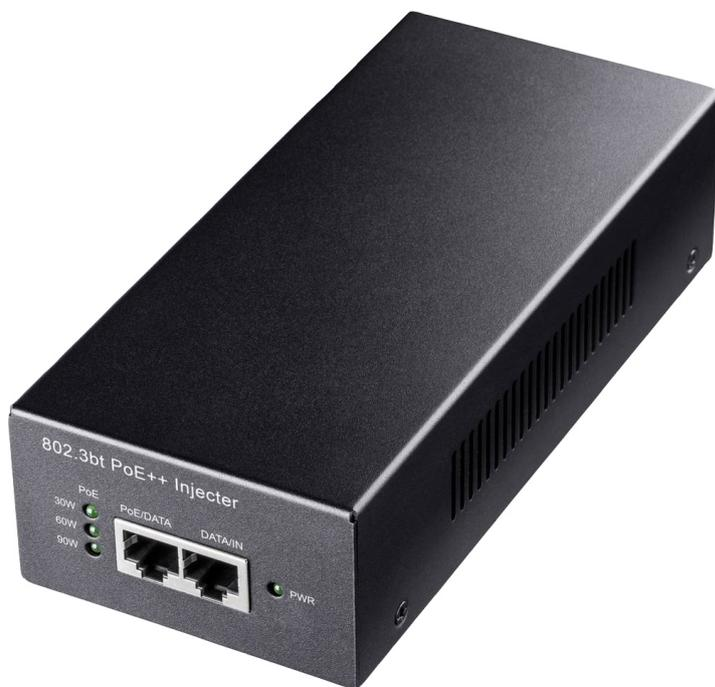
Le G-Cam/PoE-Adapter-09 est un injecteur PoE à port unique, compact et rentable. Il peut convertir une alimentation standard de 100~240V/AC en courant continu basse tension, qui passe ensuite sur un câble LAN existant pour alimenter des accessoires réseau conformes à la norme IEEE 802.3, comme l'alimentation à distance de points d'accès LAN(WAN) sans fil, de caméras de sécurité IP, de téléphones VoIP et d'autres installations à faible densité de ports.
