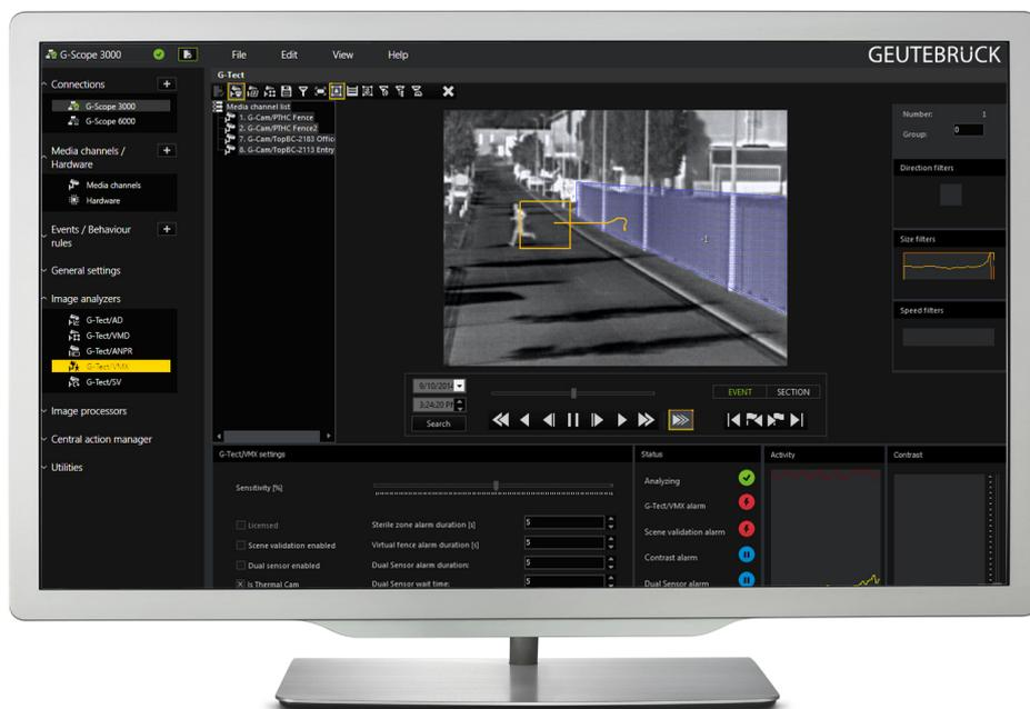
Cette option permet une analyse vidéo VMX complète. Il se caractérise par sa grande précision et sa fiabilité. Avec un modèle 3D virtuel de la zone à sécuriser, les objets peuvent être détectés avec une perspective exacte et le taux de fausses alarmes réduit. Cette analyse vidéo est donc particulièrement adaptée à la surveillance périmétrique.
