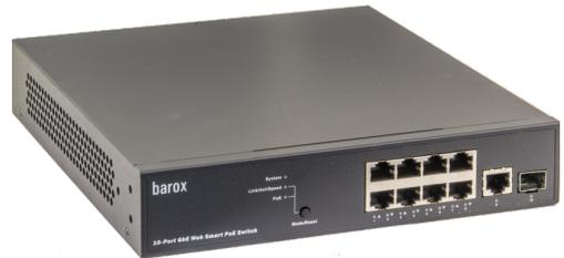
Dieser videoptimierte Switch wurde eigens für Anwendungen mit hoher Datenlast, wie z.B. Video over IP, Video streaming auch in Verbindung mit Multicast entwickelt. Durch das PoE lassen sich IP-Kameras über das Datenkabel speisen. Die kompakte Bauform und die reduzierte Portzahl machen diesen Switch ideal für kleinere Anlagen oder als abgesetzte Einheit in einem grösseren Verbund. Mit den weitreichenden Managementmöglichkeiten lassen sich auch komplexe Netzwerkanforderungen erfüllen.
