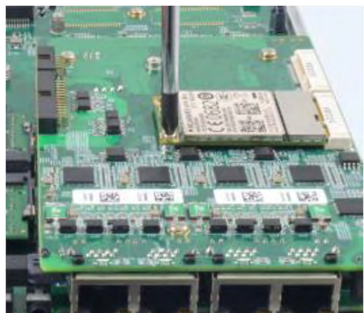
Gesichert mit Rundkopfschraube M2,5
