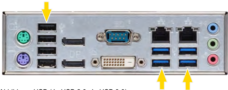
Abbildung: USB (4x USB 2.0, 4x USB 3.0)
