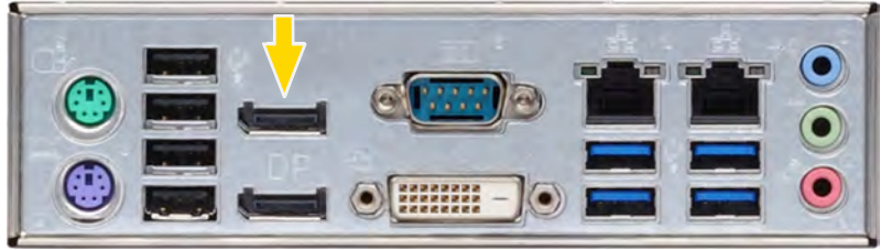
Figure : prise DisplayPort (2x)
