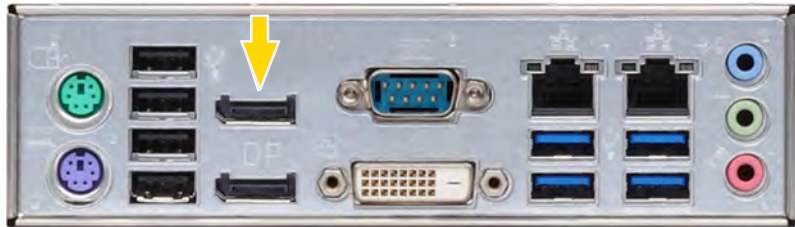
Abbildung: DisplayPort Anschluss (2x)
