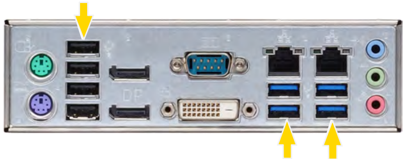
Figura: conexiones USB (4x USB 2.0, 4x USB 3.0)
