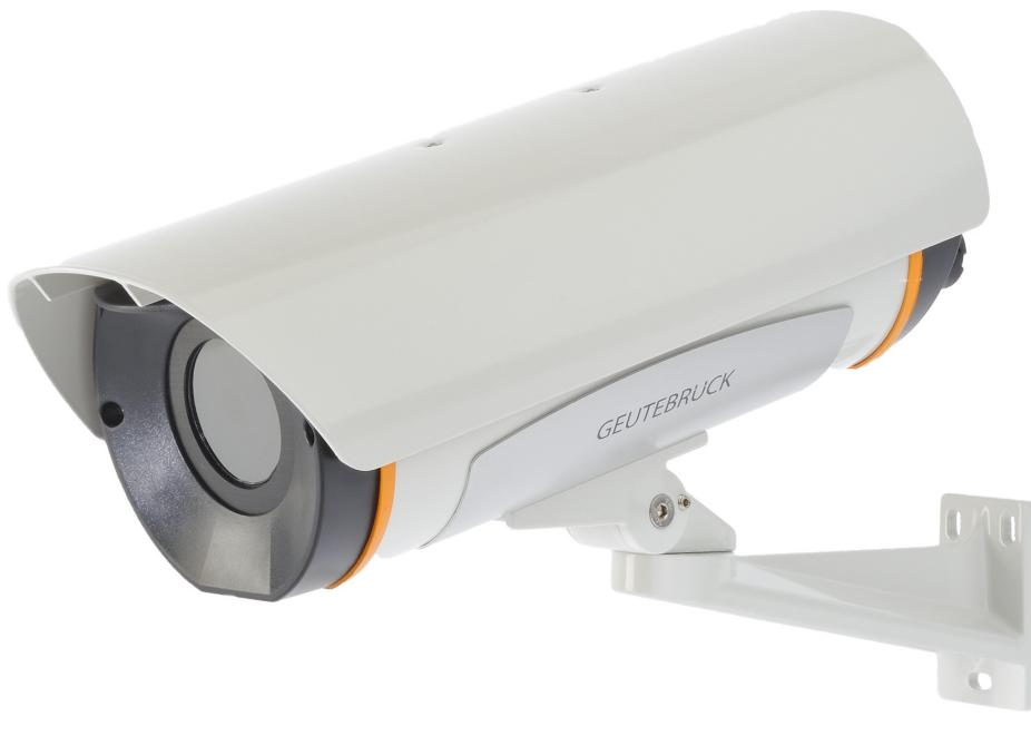
Die Wärmebildkamera ermöglicht die Observierung bei sehr schwachem Licht oder unwegsamen Gelände. Mit einer Bildrate von 9 Hz und einem Blickwinkel von 9 Grad wird eine Erkennung von Personen in bis zu 725 Meter Entfernung ermöglicht. Das Wetterschutzgehäuse bietet optimalen Schutz vor Witterung und Sonneneinstrahlung.
